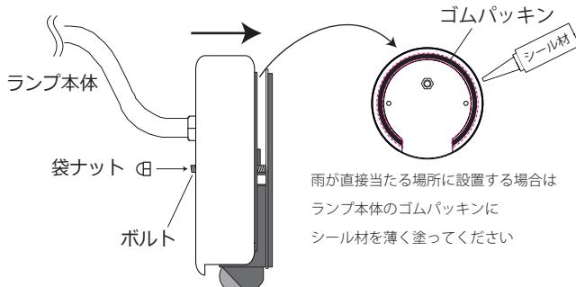
袋ナットはしっかりと締め、ランプ本体をベースプレートに確実に固定してください。
