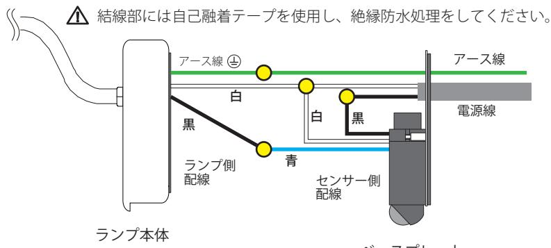
※アース線を接続してD種接地工事をしてください。
