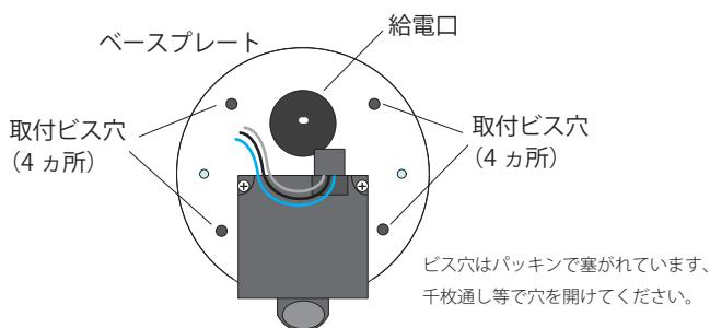
袋ナットを取り外し、ベースプレートをランプ本体から取り外します。取付ける場所にベースプレートをあてて、位置を確認し、ビス穴の位置など、壁面に印をつけてください。
