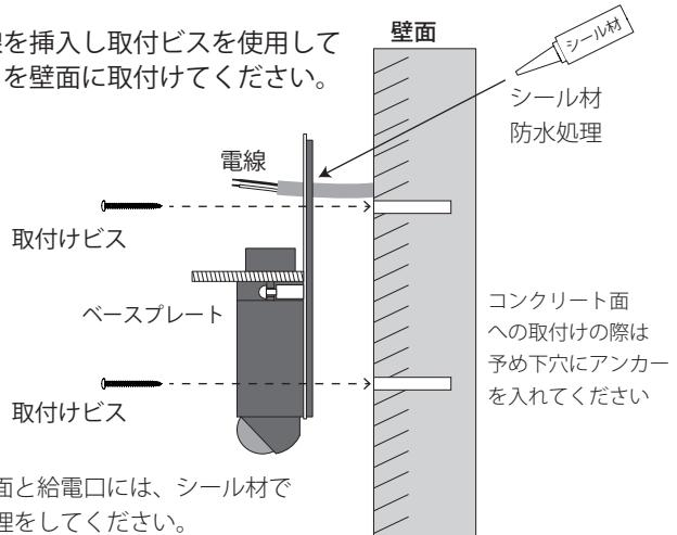
※取付け面と給電口には、シール材で防水処理をしてください。
