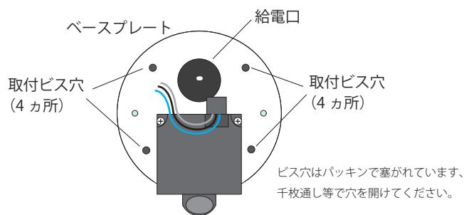
給電口から電線を挿入し取付ビスを使用してベースプレートを壁面に取付けてください。
