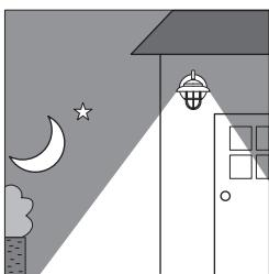
暗くなると照明が点灯しタイマーで設定した時間が経過するまで人感センサーは停止し、連続して点灯します。
