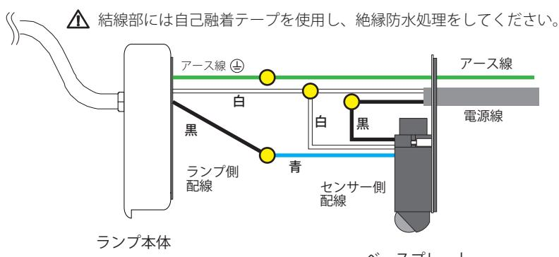
取付が完了したら、電源を入れ、照度スイッチを「テスト」に入れ感知エリアを調節してください。※表面の「人感センサー操作部の設定」を参照
